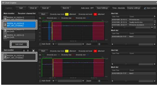
2 Sélectionnez un canal récepteur différent dans la liste de canaux récepteurs de la zone de moniteur principal.
