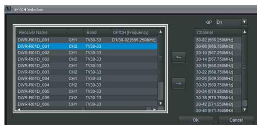
5 Sélectionnez le canal de fréquences que vous souhaitez attribuer au canal récepteur sélectionné dans la colonne [Channel] et cliquez sur [<-].
