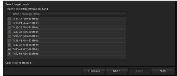
Les bandes de fréquences qui s'affichent sont identiques à celles qui peuvent être sélectionnées pour le réglage BAND du récepteur.
