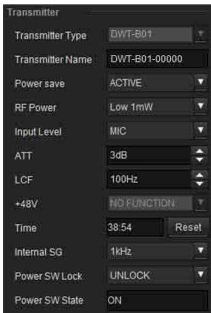
**Transmitter Type** : en mode connecté, ce réglage ne peut pas être modifié. Spécifiez le modèle de l'émetteur apparié au récepteur en mode déconnecté.
